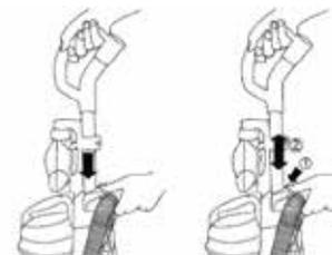
2. Asegúrese siempre de colocar el cable de alimentación pasando por el clip ubicado detrás del mango. Esto evitará posibles accidentes como pasar la aspiradora encima del cable y generar algún tipo de daño.
