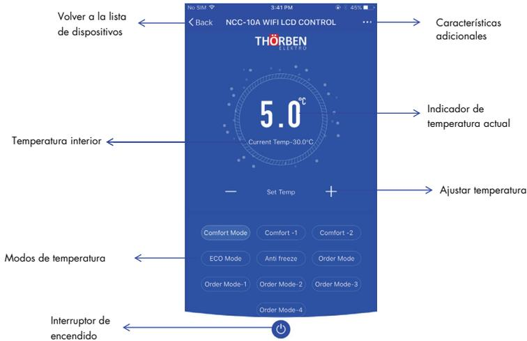
3.3.2 Presione [Interruptor de encendido / apagado] para encender o apagar el calefactor.
